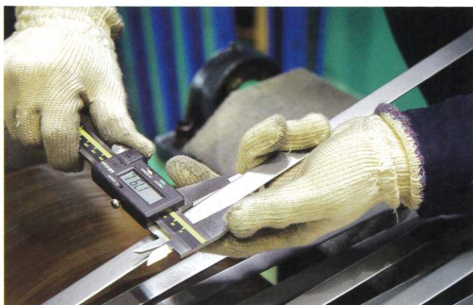
プレス加工時の詰まりの原因となるため、加工幅や切断面の形状は入念にチェック
